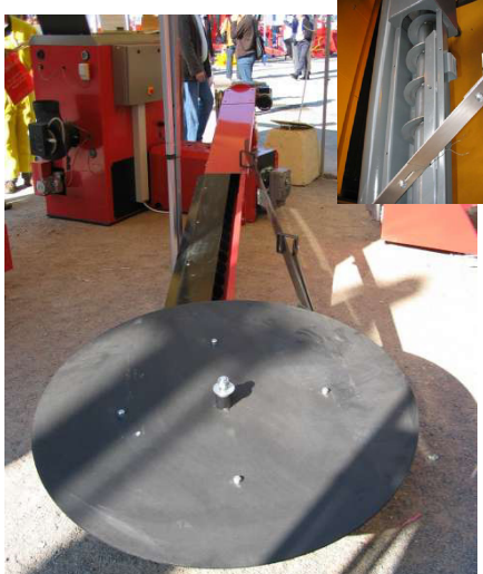
Extracteur rotatif et sa vis sans fin
